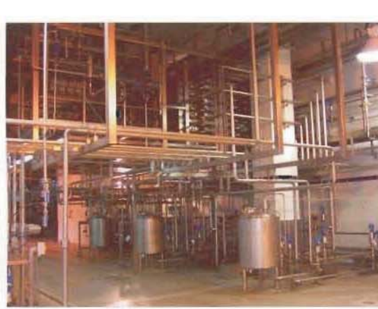
▲ Bereich Käseerei: Teil der Anlage mit drei Thermo-Quark Linien
