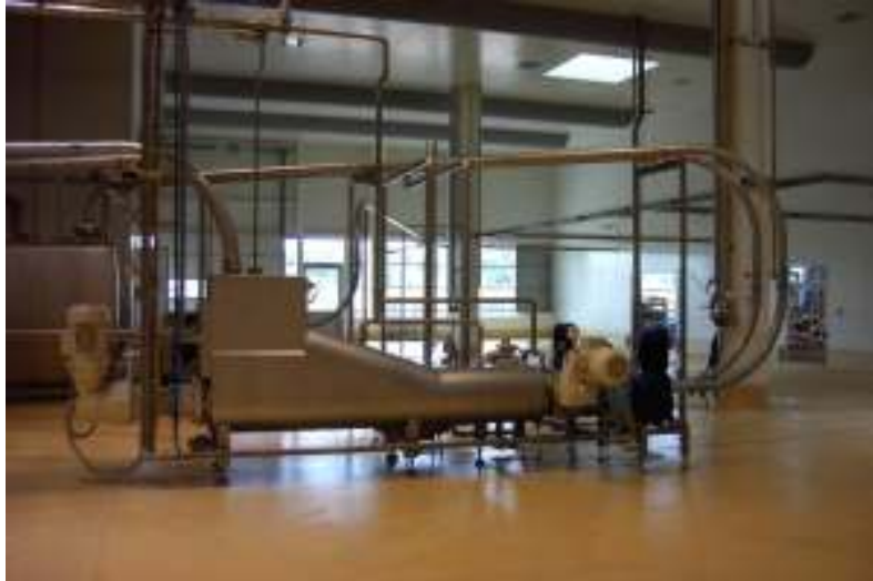
Hygienische Installation einer Anlage auf sauberem, gut zu reinigenden Boden (System hier: Ucrete)
