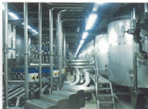
Um strikte Hygieneanforderungen einzuhalten, hat Eilon Tavor nicht weniger als acht CIP-Anlagen im Einsatz
