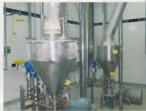
Trockenzutaten werden dem Produkt in einer separaten Halle über Guerin-Linien zugesetzt
