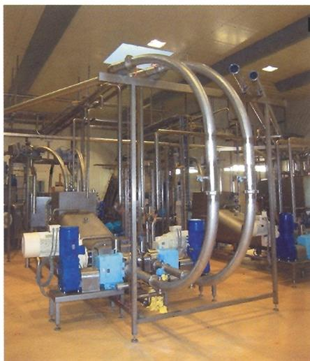
**Im Reworker werden die Butterblöcke zerkleinert und homogenisiert**
