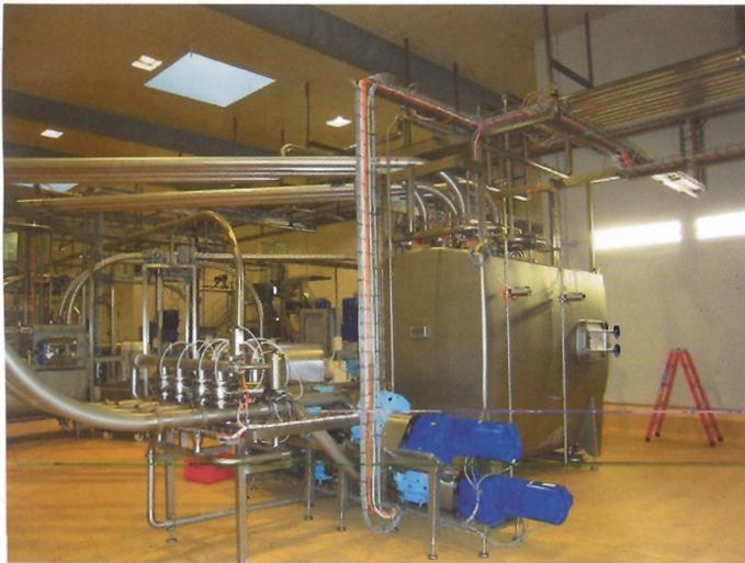
Von den Buttersilos aus wird die Butter sternförmig auf die Abfüllanlagen gepumpt
