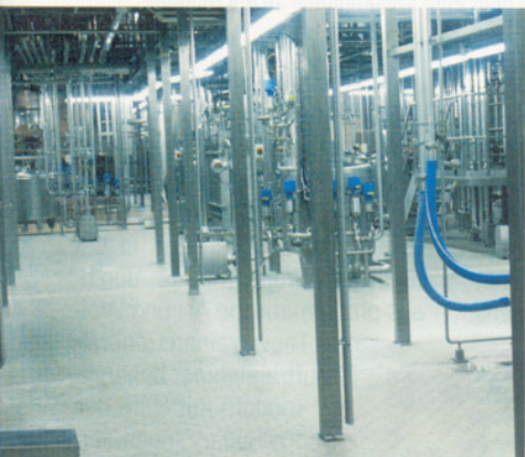
Um die verschiedenen Kosher-Grade einzuhalten, setzt die Molkerei mehrere getrennte Prozesslinien ein
