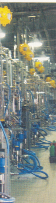
Fruchtzubereitungen werden über zehn TDS in-line-Dosierstationen zugesetzt
