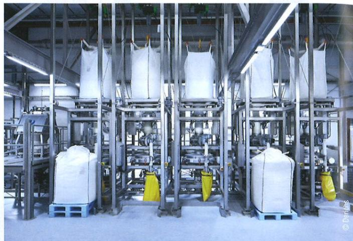
Verwogene Big-Bag Entleerstation mit integriertem Vibrationsieb für Rohstoffe die in Milch aufgelöst werden
