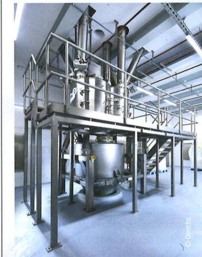
Zwei-Wellen-Vertikal-Mischer für Produkte welche erst nach dem Trocknungsprozess gemischt werden
